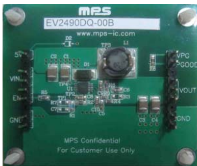
(L x W x H) 1.8" x 1.8" x 0.4" (4.6cm x 4.6cm x 1.0cm)
