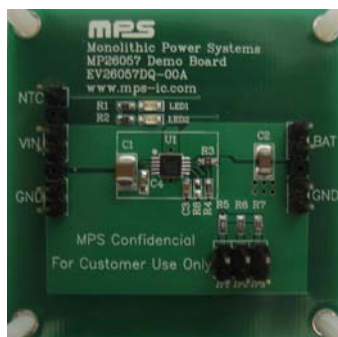
(L x W x H) 2.0" x 1.9" x 0.5" 5.0cm x 4.8cm x 1.3cm
