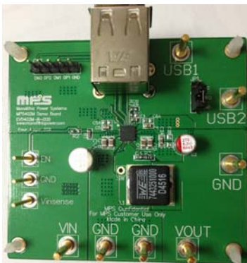
(L x W x H) 6.5cm x 6cm x 1.7cm (Four Layer PCB)
